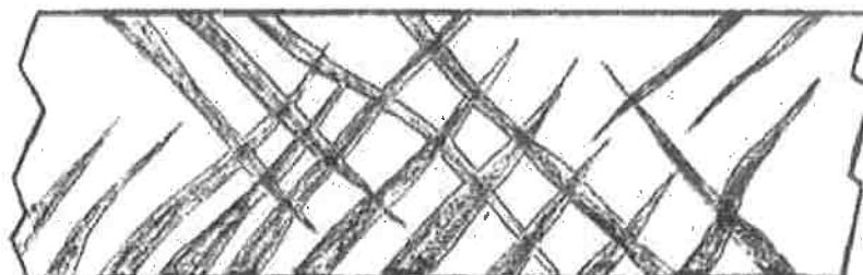
Figura 2.3: ilustração de bandas de cisalhamento que se estendem ao longo de toda a espessura de um corpo conformado [16].
